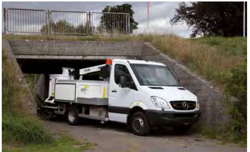
Eine Versalift mit einer niedrigen Transporthöhe kann unter niedrigen Brücken fahren
