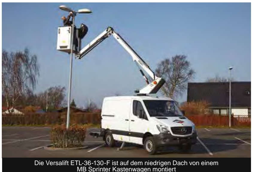
Eine Versalift mit einer niedrigen Transporthöhe kann unter niedrigen Brücken fahren
