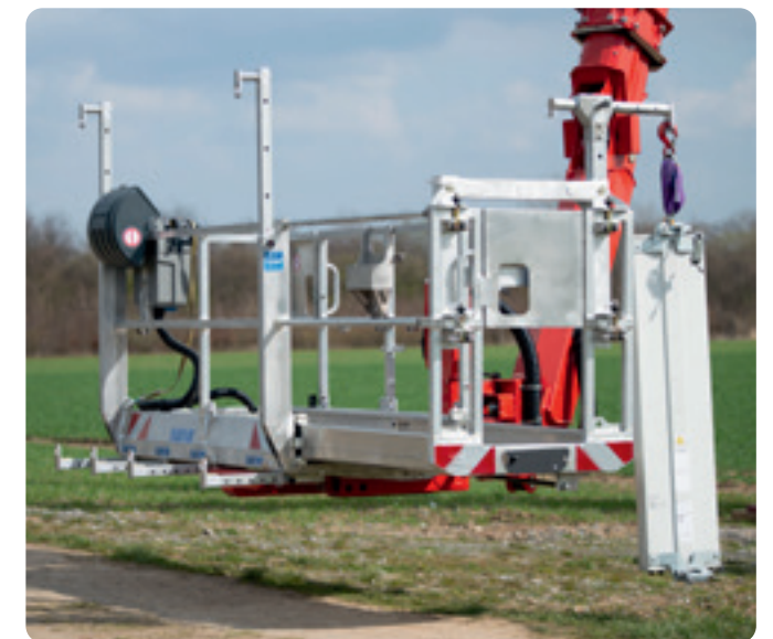
Links: das Ruthmann Lifting-Eye-System LES 100 erlaubt durch die vier möglichen Montagepunkte am Arbeitskorb z.B. auch die Montage von Bauteilen hinter Störkanten.
