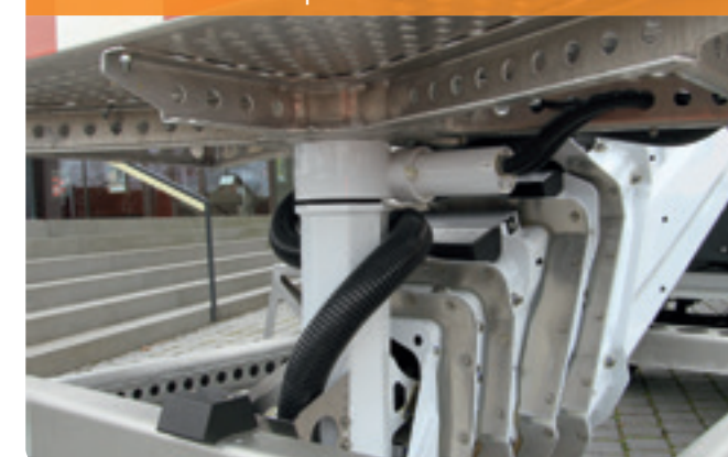
Schneckenantrieb Korb | Worm drive basket
