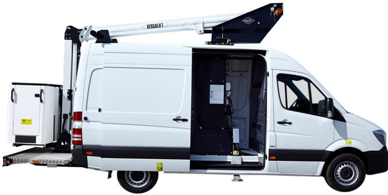
■ Länge: 7,270 mm    ■ Höhe: 3,490 mm    ■ Radstand: 3,665 mm
