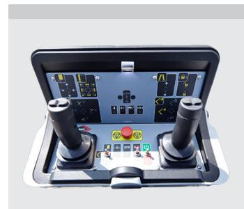
Lastmoment-Steuerung: Variable Reichweite und bis zu 2 gleichzeitige Bewegungen (1 per Joystick)
