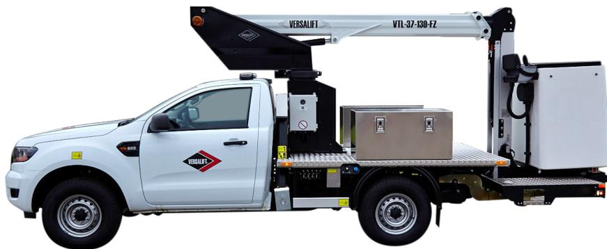
■ Länge: 6,625 mm    ■ Höhe: 2,555 mm    ■ Radstand: 3,220 mm
