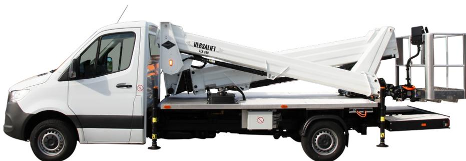
■ Länge: 7,825 mm    ■ Höhe: 2,260 mm    ■ Radstand: 4,325 mm
