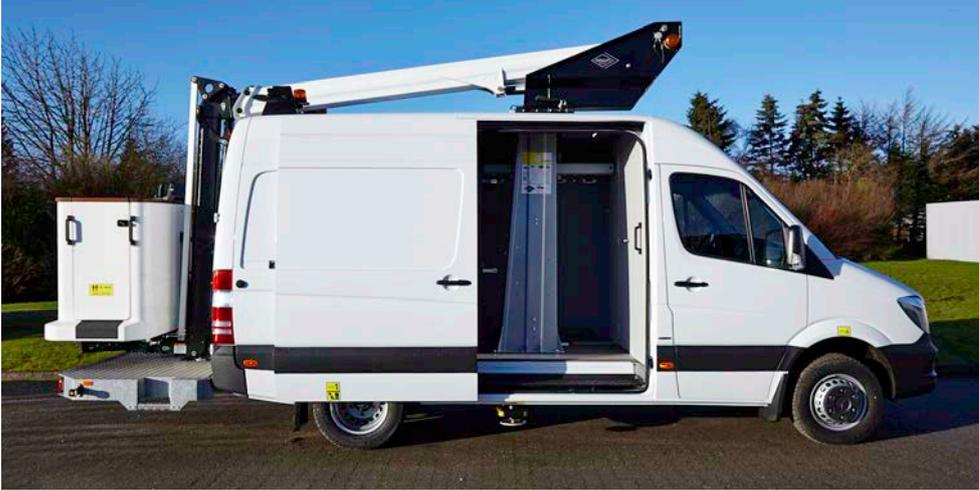
**Länge:** 7.405 mm      **Höhe:** 3.490 mm      **Radstand:** 3.665 mm
