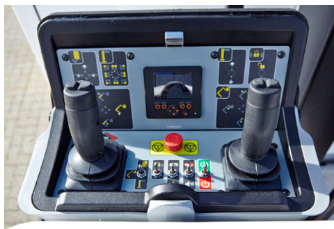
Vollproportionale-CANbus-Steuerung: Variable Reichweite (mit Wägezelle) und bis zu 4 Bewegungen gleichzeitig
