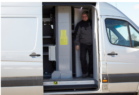
Direkter Durchgang vom Fahrerhaus zu dem Korb (Optional)
