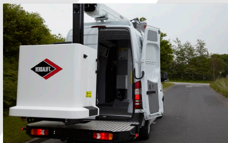
Hintere Plattform mit asymmetrischer Korbablage
