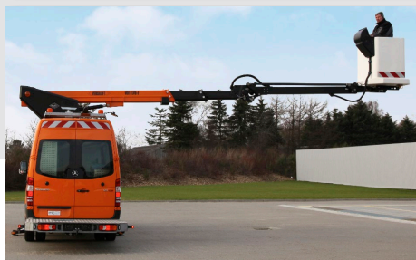
Kein Überhang der Turmverkröpfung über die Spiegelbreite
