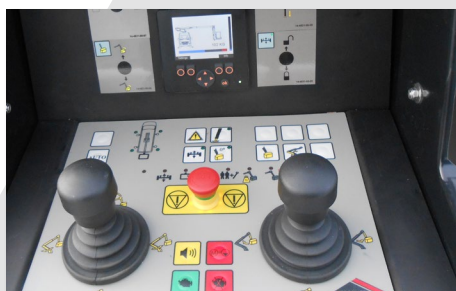
FPC: Vollproportional CANbus Steuerung mit Display
