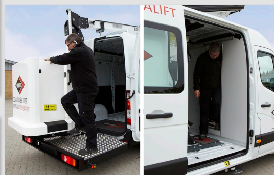
“WTS”: Direkter Durchgang vom Fahrerhaus zu den Korb (optional)
